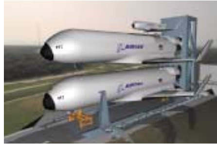
Boeing firmasının tasarladığı mekiklerde yakıt tanklarının da kanatları var. Böylece fırlatma sırasında mekikten ayrılan yakıt tankları güvenle yere ulaşacak ve yeniden kullanılabilirler.
